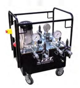
Centralina a 4 mandate indipendenti con valvole overcenter singole (700 bar) per sincronismo del carico sia in fase di salita sia di discesa.
