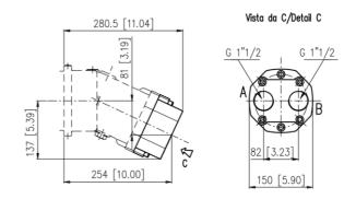
S1, S2: Drenaggi (1 tappato) / Drain ports (1 plugged) - 1/2 G (BSPP)
