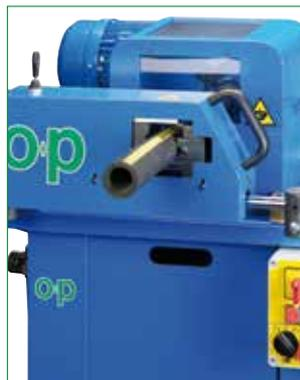
◀ MORSA PNEUMO-IDRAULICA
