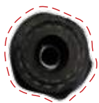
Pressatura irregolare ottenuta con macchina della concorrenza Irregular crimping obtained with other machines not supplied by OP srl
