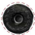
Pressatura circolare ottimale ottenuta con TNT8 Optimal crimping result obtained with TNT8
